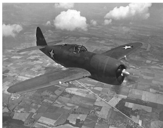
図17 連合国軍戦闘機P-47 通称「サンダーボルト」乗組員:1名、長さ:36ft、翼幅:40ft、速度:800mile
